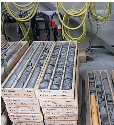
Bohrkerne geben Aufschluss darüber wie der Untergrund einer Bohrung beschaffen ist.
